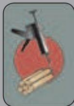
Brandschutzstopfen auf beiden Wandseiten einbringen, Restspalt und Kabelzwischenräume mit Brandschutzkitt Kombi verfüllen.
