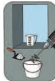
Mörtel trocken vormischen. Erst Wasser, dann Mörtel in den Mischbehälter. 3 Min. mischen bei 300-400 U/min.
