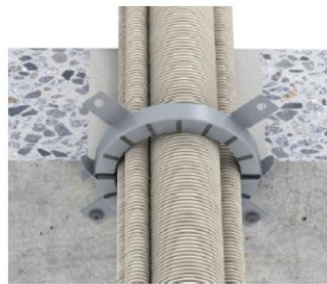
Es ist die zum jeweiligen Leerrohrbündel passende Brandschutzmanschette vom Typ Würth RK1 auszuwählen. Alle Restöffnungen um das Leerrohrbündel in Wänden oder Decken müssen mit Beton, Mörtel oder Gips verfüllt werden. Die Zwickel zwischen den einzelnen Leerrohren müssen nicht verfüllt werden.
