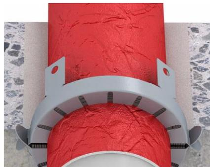
**Einbauschritte für mit Schallschutzschlauch ( rot dargestellt ) isolierten oder unisolierten Rohren:**
