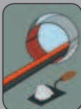
Restspalt mit Brandschutzmörtel, Brandschutzzement oder bei leichten Trennwänden mit Gips verschließen
